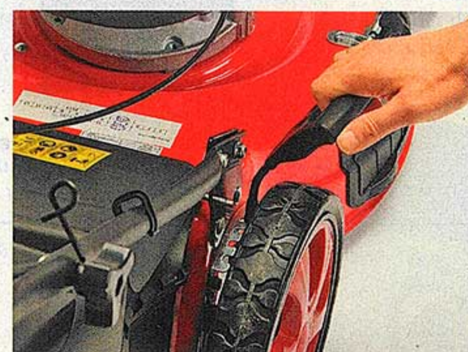
Mit einem gut greifbaren Rastgriff wird die Schnitthöhe zentral vorgewählt.
